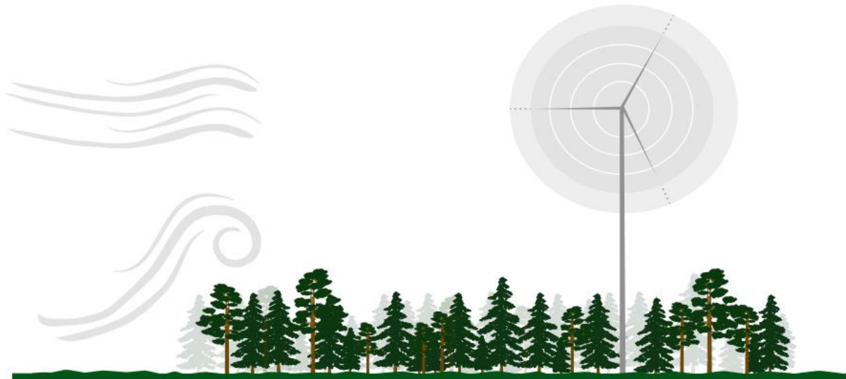
Figur 4. Närmast markskiktet är luftflödet turbulent till följd av friktion. För att minska slitage på vindkraftverken och öka produktionen av el behöver verken komma upp ovanför turbulensen.
