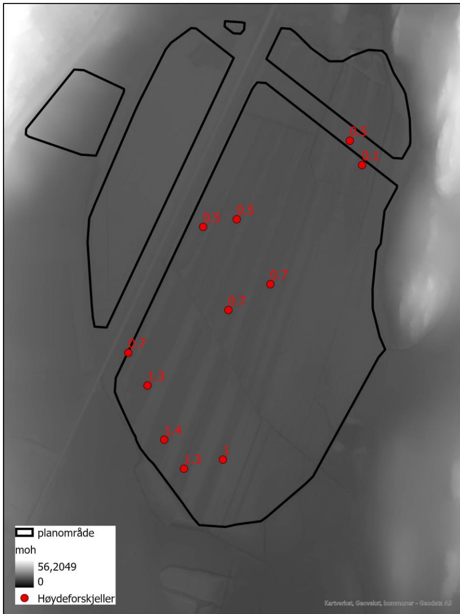
Figur 5-3. Terrengforskjeller mellom uttaksområder for torv (mørkegrå) og andre områder (lysere grå). Tallene viser høydeforskjeller mellom uttaksområde og nærliggende areal hvor ikke torv er tatt (se eksempel i Figur 3-2). Grøfter vises som smale mørke linjer, torvuttak vises som store mørke flater. Høydeforskjeller mellom flater hvor torv er tatt ut og areal utenfor disse vises i meter. Iht. Abel m.fl. (2011) er det vanskelig å reetablere hydrologi med større høydeforskjeller enn 1,5 meter.
