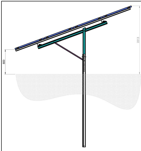
Figur 2-2. Eksempel på struktur, tverrsnitt. Kilde: ZIM 1-V Zimmermann PV-Stahlbau. https://www.pv-stahlbau.de/en/fix-tilt-systems/zim-1-v/ .
