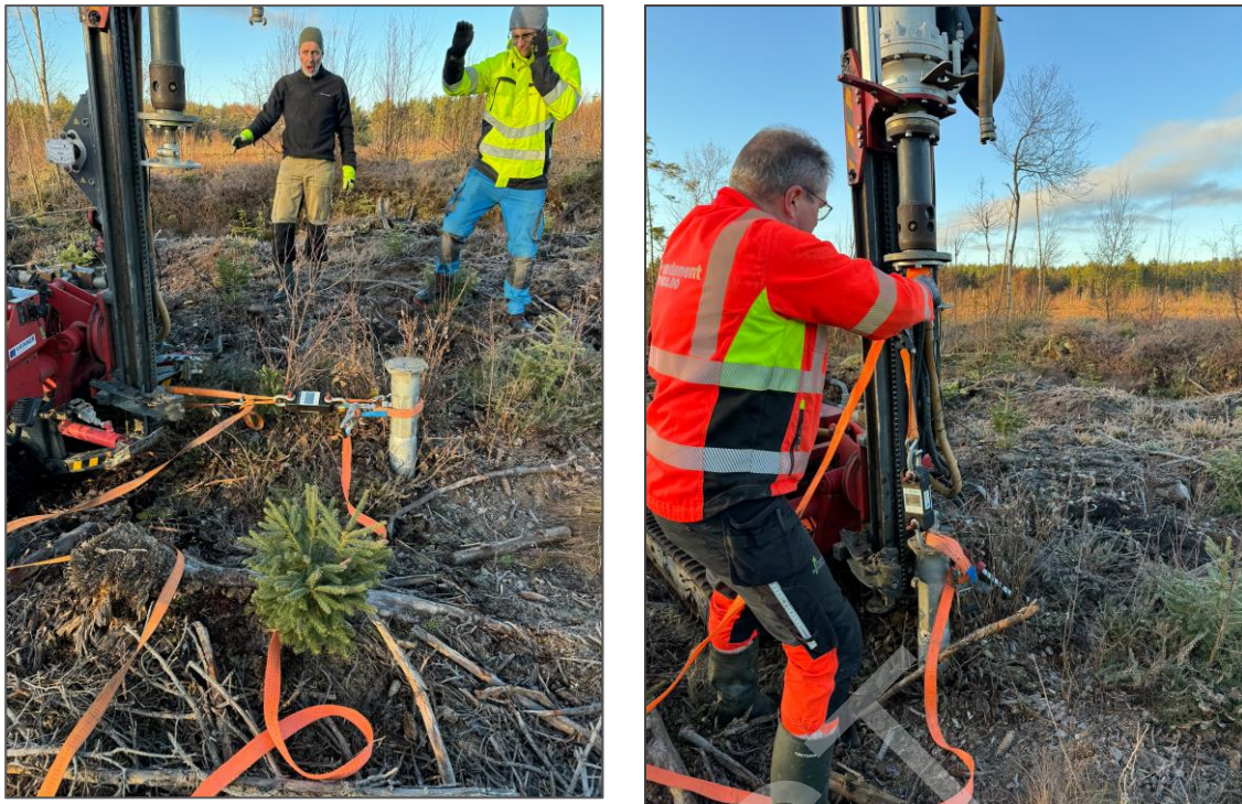
Figur 2-3. t.v.: pull-testing for horisontal kapasitet. t.h.: pull-testing for vertikal kapasitet
