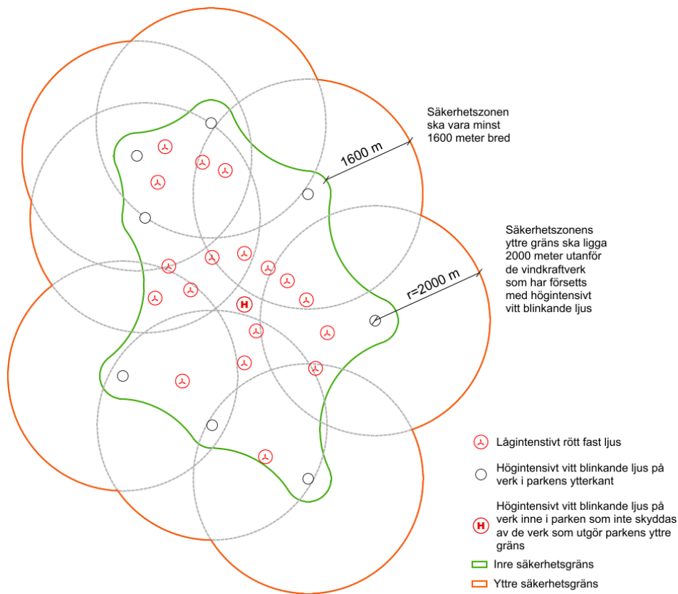
Figur 9. Beskrivning av hindermarkering enligt Transportstyrelsens nuvarande föreskrifter för en samlad vindpark för verk med totalhöjd över 150 meter.
